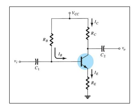
$$V_{CE} = V_{CC} - I_{C}R_{C} - V_{E}$$
