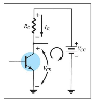
$$V_{BE} - V_{CE} - V_{BC} = 0$$
